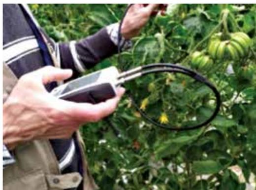
Figura 7 – Determinação da concentração da clorofila.
