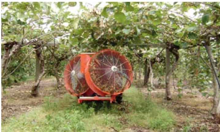
Figura 10.3. Passagem de uma máquina com turbina para potenciar a polinização num pomar de actínídea.
