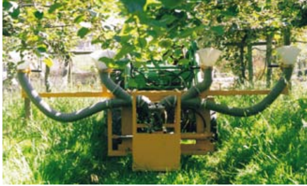
Figura 10.5. Aplicação manual (A) e mecânica (B) de pólen por via seca.
