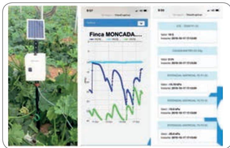
Figura 13. Sensores de humedad en parcela agrícola y su aplicación para smartphone
