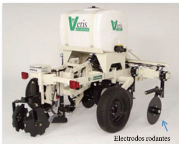
Figura 2 - Plataforma de Sensores de CEa y pH VERIS-3150. Fuente: Veris Technologies, Inc.
