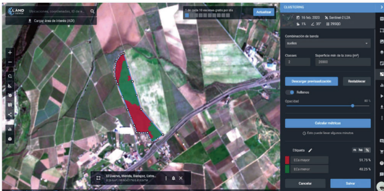
Figura 40 - Clusterización realizada a partir de la herramienta gratuita Landviewer (EOS, Menlo Park, CA 94027 EE.UU), con menos potencial pero fácil de utilizar y de acceso gratuito. Fuente: Landviewer
