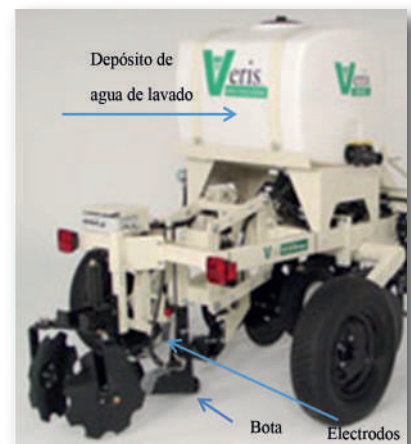
Figura 5 - Equipo de muestreo de pH. Fuente: Veris Technologies, Inc.
