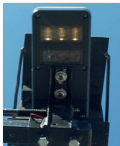
Figura 11 - Sensor de vegetación multiespectral activo.
