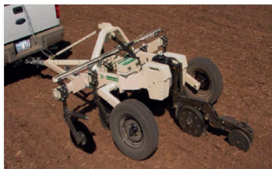
Figura 6 - Equipo de medición de M.O. VERIS Optic Mapper. Fuente: Veris Technologies, Inc.
