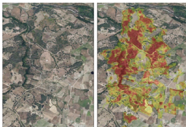
Figura 119 - Cálculo de severidad de incendio forestal calculado a partir de imágenes de Sentinel 2 en Villanueva de la Vera el 10/09/2019 (Cáceres, España). Se observa en la parte centro-oeste, alta severidad en zonas de robleal. Estas circunstancias solo se observan en condiciones de alto estrés hídrico.
