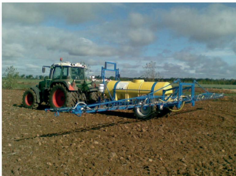
Figura 10 - Equipo de pulverización de dosificación variable.
