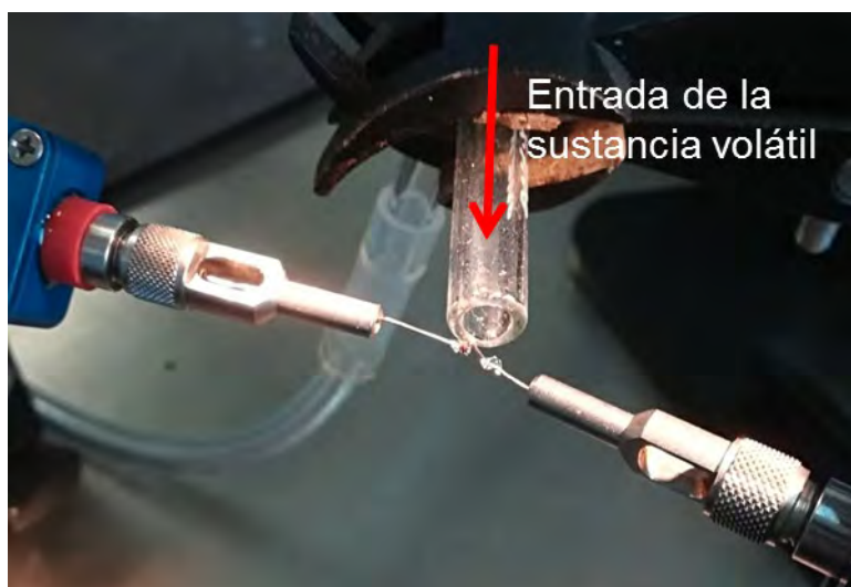
Figura 8.2.6 Detalle de la conexión de la cabeza de la avispa entre los electrodos de plata conectados al detector de electroantenografía
