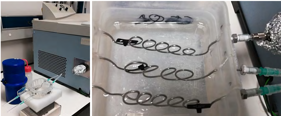
Figura 7.1. Equipo adaptado para cromatografía de gases preparativa (izquierda) y detalle de los bucles utilizados para el aislamiento de la sustancia (derecha)
